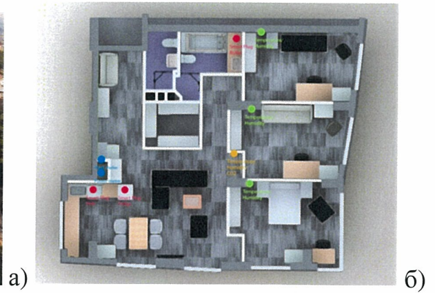
Рисунок 12 – Пілотний об'єкт: а) житловий комплекс «Панорама», б) схема встановлення смартобладнання в типовій квартирі житлового комплексу
