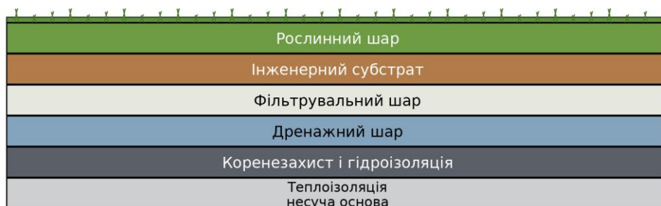
Рис. 1. Узагальнена схема основних шарів зеленої покрівлі
