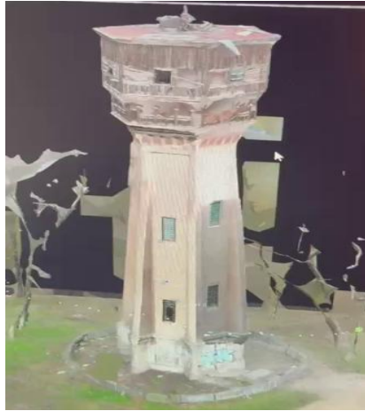
Рис. 1. 3D-модель водонапірної вежі, отримана методом фотограмметрії
