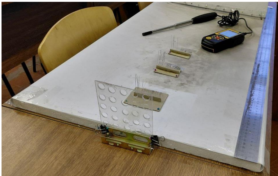
Рисунок 7 – Модель захисного бар'єру (пористість бар'єру 30%).
